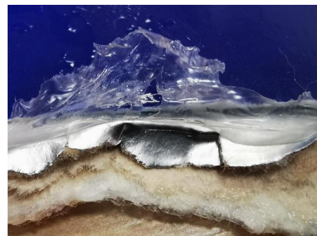
Photos des différentes couches de matériaux dans une brique de jus de fruits
